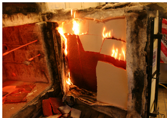
05 Brandversuch eines 44 mm Lehmputzsystems nach 80 Minuten
