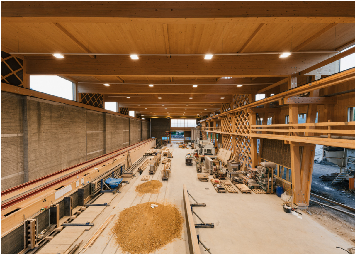
10 ERDEN Werkhalle – Produktionsstätte für vorgefertigte Stampflehmelemente
