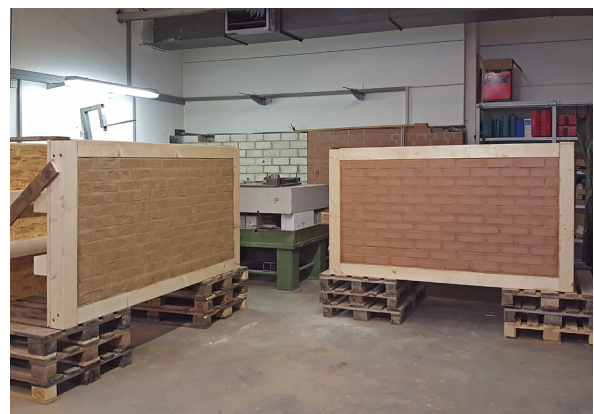
Prüfkörper Lehmsteinmauerwerk für Zugprüfungen
