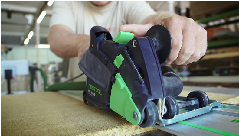
Lehmbauplattenzuschnitt mit dem FESTOOL Trennsystem
