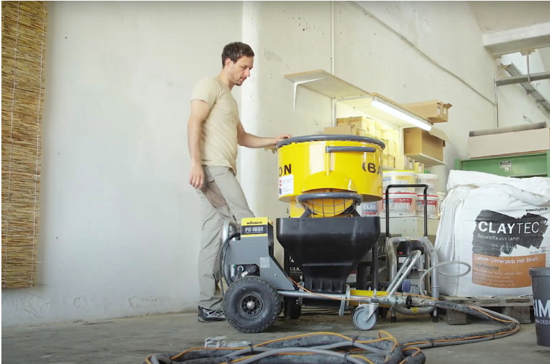
Equipment für erdfeuchte Lehmputzmörtel BARON/WAGNER
