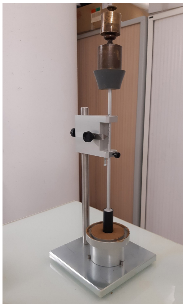
02 Verwendung der Stößel-Gewichtstest zur Ermittlung der Fließspannung der Lehmprobekörper
